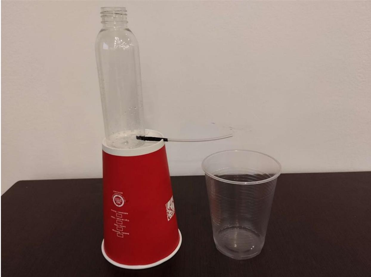
7. Coloque o copo de água abaixo do tubo capilar de modo que ele colete o líquido que será drenado. Remova o seu dedo e deixe a solução fluir livremente através do tubo capilar até que o nível atinja a marca superior e então acione o cronômetro. Pare o cronômetro quando o líquido atingir a marca inferior.
