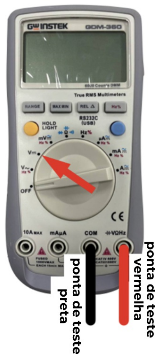
Figura P-3. mostra o multímetro utilizado neste exame, juntamente com a localização das sondas e a seleção de modo.
